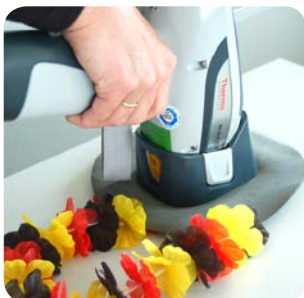
Röntgenfluoreszenzanalysator Ermittlung von 30 Schwermetallen
